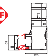
Sezione montante laterale, profilo anta mobile e guarnizioni di tenuta interne ed esterne.
