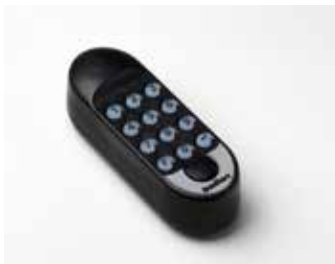
Tastiera a codice retro illuminata wireless a 4 canali rolling code KQ 433 FM, alimentazione a batterie (dim. 113x40x37 mm). (cod. MB.18.1) (optional)
