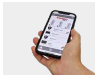
BallanNET è un sistema che consente di gestire remotamente porte da garage, cancelli, il BoxAlarm, costituito da accessori hardware (BallanNET HUB e RIOB, un BallanNET cloud-server e da una applicazione BallanNET app per smartphone con sistema operativo Android o IOS.
