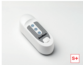
Trasmittitore murale A 3 canali rolling code KQ 433 FM, alimentazione a batterie (dimensioni 133x40x37 mm). (MB.17.1) (optional)
