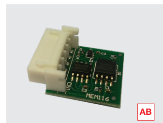
Estensione di memoria Backup (MEM 116) radio ad innesto S+ green e AB green . Si può utilizzare anche nelle riceventi da esterno come memoria di backup fino a 4000 locazioni. (SZ957) (optional)
