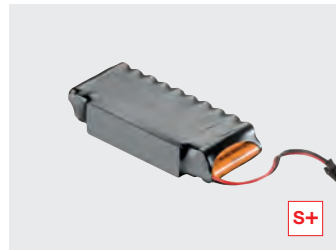
Batteria a tampone, in caso di blackout la batteria alimenta per un breve periodo l'automazione (> 5 cicli in 12 ore). Disponibile solo per automazioni S+. (cod. SZ951) (optional)
