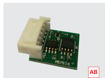
Estensione di memoria Backup (MEM 116) radio ad innesto S+ e AB. Si può utilizzare anche nelle ricevitori da esterno come memoria di backup fino a 4000 locazioni. (SZ957) (optional)
