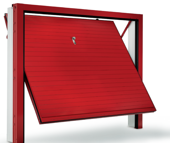
Porta basculante Dynamic Sikura HF, rivestimento esterno in Okoumé multistrato pantografato a doghe orizzontali, passo da 85 mm. La laccatura in tinta Ral 3011, la serratura con Defender art. 96 e la guarnizione inferiore in gomma sono optional.
