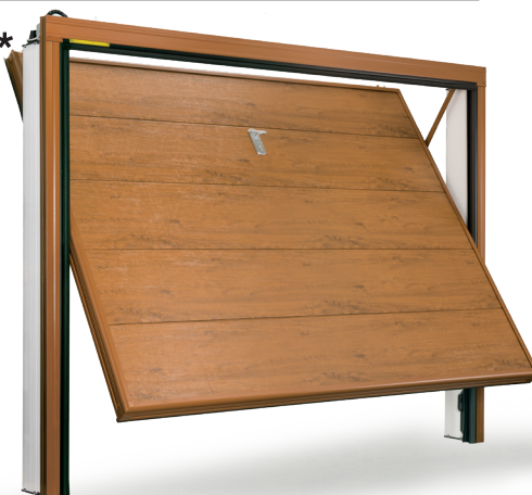
Porta basculante My Fusion Viva 400, struttura Spazio HF, con bordi arrotondati. I pannelli sono trattati esternamente con vernice superpoliestere "effetto legno", tinta noce chiaro e telaio verniciato di serie Ral 8003, finitura goffrato legno. Interno pannelli superficie goffrato stucco bianco simil Ral 9016. La maniglia art. 98 è optional.
