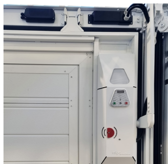
Esempio di ISY KIT ORO con sistema di controllo e scheda esterna per cablaggio accessori EVO
