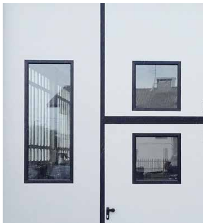
Oblò quadrati e rettangolari con profilo in alluminio ad angoli retti, completi di profilo perimetrale in alluminio colore nero, in vetro da 5+5 mm trasparente.
