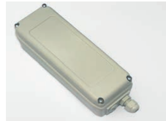
Ricevente esterna A basso consumo 2/4 uscite a 4000 locazioni. Espandibile a 4 uscite con modulo aggiuntivo cod. 10444081: ogni modulo aggiunge una uscita. Per l'utilizzo su automazioni esistenti in loco si consiglia di prevedere l'antenna aggiuntiva. (Cod. commerciale MS.23). Grado di protezione IP54.
