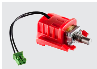
Magnete di blocco meccanico del motore, in qualsiasi posizione con una forza pari a 300 kg, protezione antifrazione SKG. Disponibile solo per automazioni S+. (cod. SZ948) (optional)
