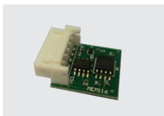
Estensione di memoria Backup (MEM 116) Con l'estensione di memoria si posso programmare fino a 500 locazioni; adatto per garage con tante utenze. Memoria aggiuntiva Ballan per ricevitore radio ad innesto S+ e AB. Durante le assistenze, è possibile riutilizzare i dati memorizzati in una nuova slitta motore. Ideale anche per garage interrati. Si può utilizzare anche nelle riceventi da esterno come memoria di backup fino a 4000 locazioni.
