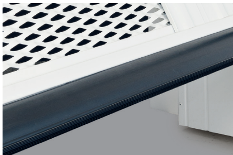
Le joint inférieur en ABS noir, H 50 mm, avec un profilé interne en aluminium et des butées d'arrêt latérales, garantit une meilleure fermeture entre le tablier et le sol.
