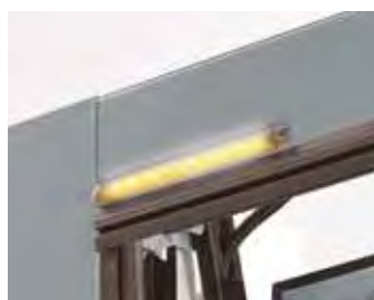
Lampeggiante a led esterno, con antenna integrata, montato e precablati (di serie).
