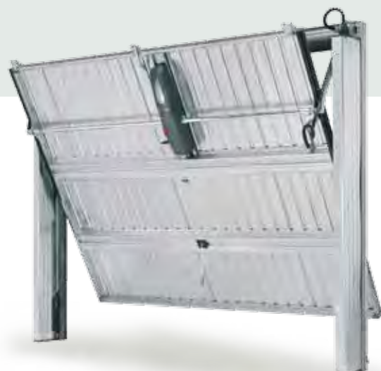
Vista interna Zink Spazio HF con automazione SIM-1. L'automazione SIM-1 prevede un motore centrale applicato su un longherone centrale (posto sull'anta mobile) con base motore e tubi di rinvio. La coppia di fotocellule interne premontate e precablate è optional.
