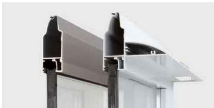
Sezioni telaio in alluminio senza rinforzo o con rinforzo, a seconda della dimensione del portone. Tutti i fissaggi sono realizzati utilizzando inserti filettati e viti metriche a garanzia della massima tenuta meccanica e durata nel tempo.
