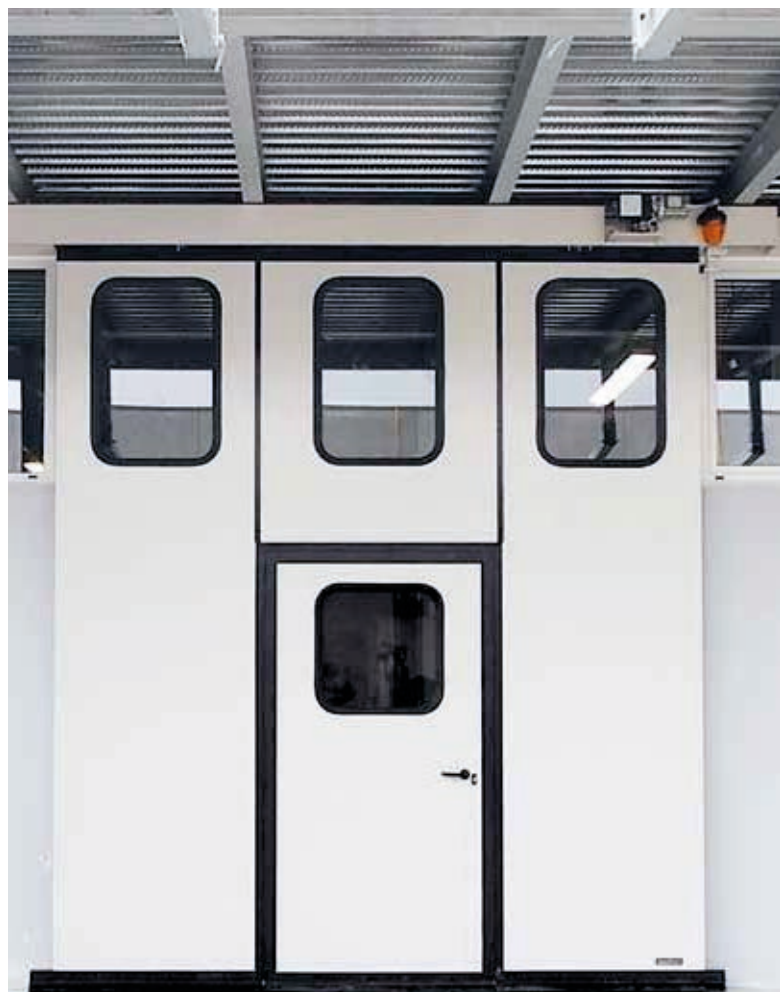
Porta pedonale senza traverso inferiore (senza soglia) ricavata su pannello singolo, realizzata in profilo di alluminio colore nero, completa di maniglione antipanico, con scrocco laterale, cilindro e maniglia esterni.
