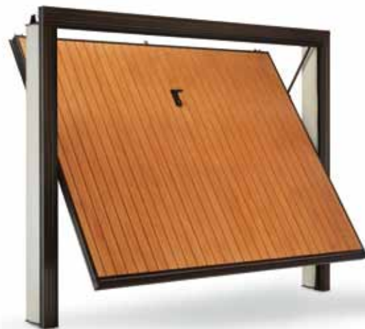
Porta basculante Slide Spazio HF, rivestimento esterno in Okoumé multistrato pantografato a doghe verticali, passo da 85 mm. La predisposizione alla motorizzazione HF, il trattamento completo in tinta 1 e la guarnizione inferiore in gomma sono optional.
